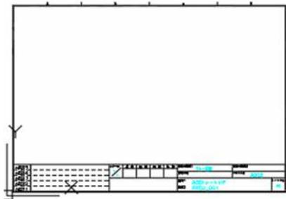
AutoCAD Electrical を効果的に使用するには、作図環境設定を行ったテンプレート、すなわち図枠を作成することが必須となります。
