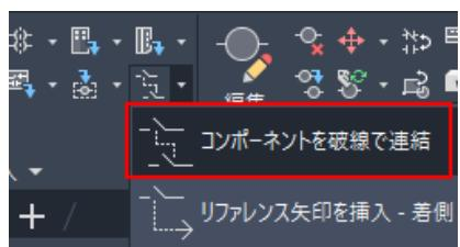
1つのデバイスを回路図では複数に分けて描くことがあります、離れてしまうと同一デバイスと判断できなくなる為、シンボル同士を連結する破線などを作図する場合があります。
